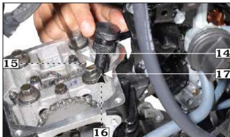
(14) Calibrador de espesores
