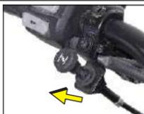
5. Tire la palanca del cebador hacia afuera a la posición "ON" como se indica (utilice el cebador en condiciones de frío).
