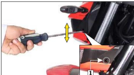
**(1) Tornillo de ajuste del faro delantero**
