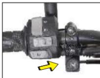
7. Empuje la palanca del cebador hacia adentro a la posición "OFF", como se indica, después de que el motor se haya calentado lo suficiente para tener una respuesta estable del acelerador.
