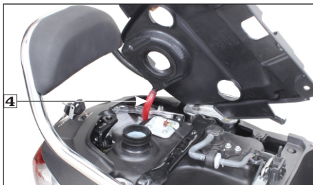
(4) Tubo de drenaje
